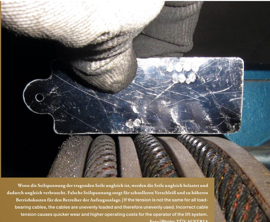
Wenn die Seilspannung der tragenden Seile ungleich ist, werden die Seile ungleich belastet und dadurch ungleich verbraucht. Falsche Seilspannung sorgt für schnelleren Verschleiß und zu höheren Betriebskosten für den Betreiber der Aufzugsanlage. | If the tension is not the same for all load-bearing cables, the cables are unevenly loaded and therefore unevenly used. Incorrect cable tension causes quicker wear and higher operating costs for the operator of the lift system.
