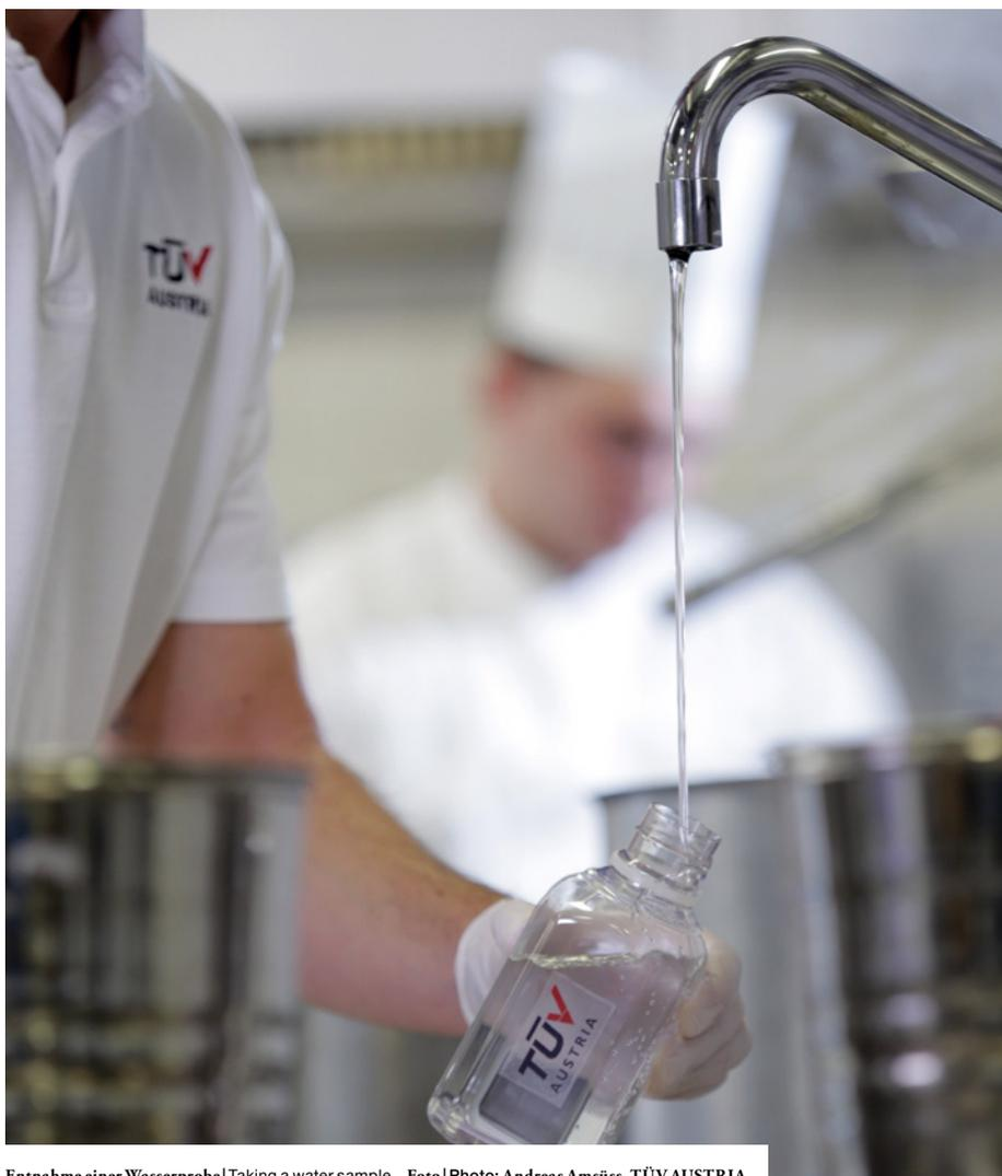
Entnahme einer Wasserprobe | Taking a water sample Foto | Photo: Andreas Amsüss, TÜV AUSTRIA
