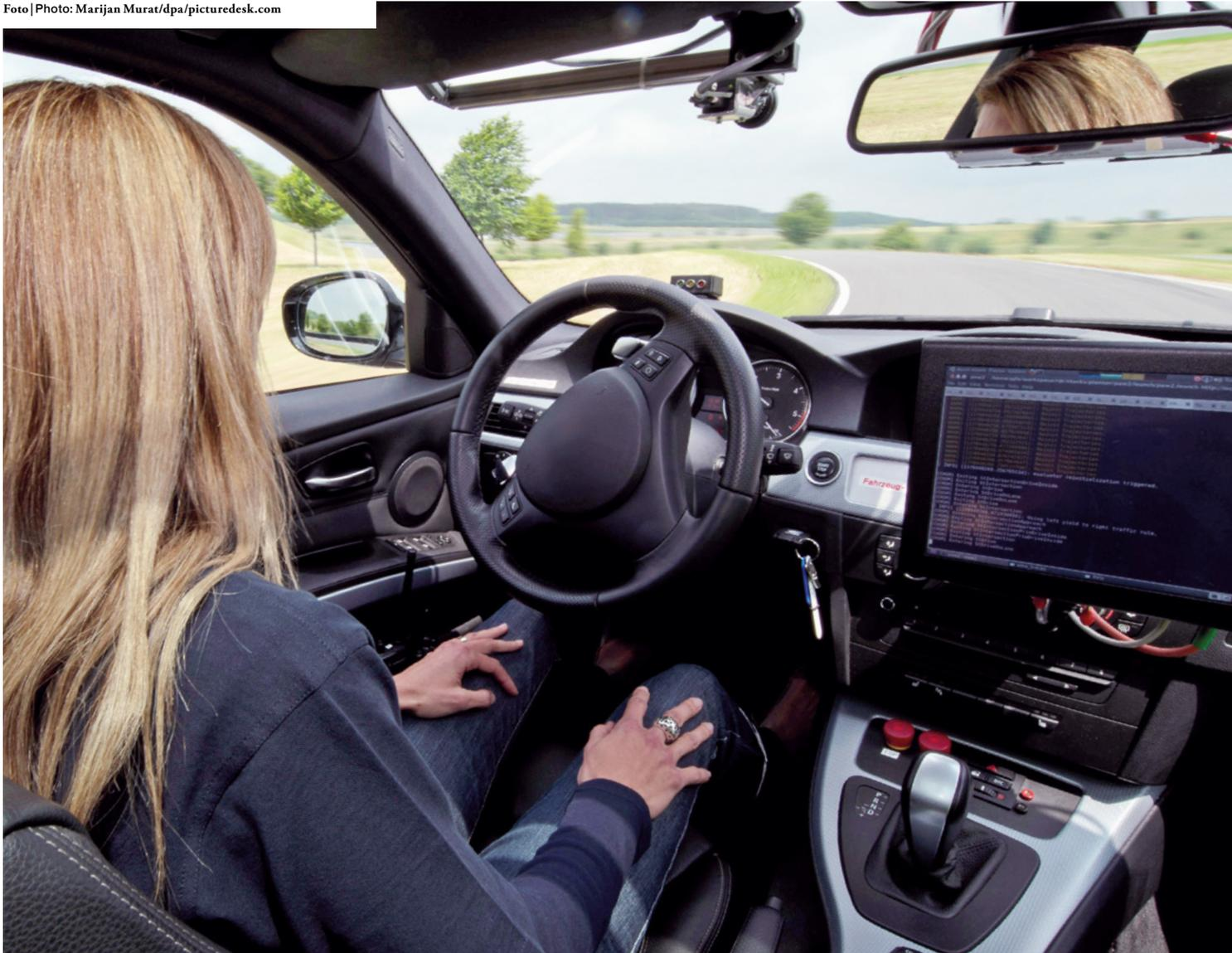
➔ Autos erkennen mittlerweile Fahrstreifen, Verkehrszeichen, Fußgänger und andere Verkehrsteilnehmer. Stauassistenten lenken, beschleunigen und bremsen im richtigen Moment – der Fahrer überwacht lediglich. Fahrzeuge übernehmen beim automatisierten Fahren sukzessive mehr Aufgaben.
